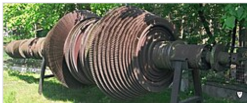
Wirnik turbiny parowej Parsonsa z ORP Wicher II w Skansenie Broni Morskiej w Helu.
