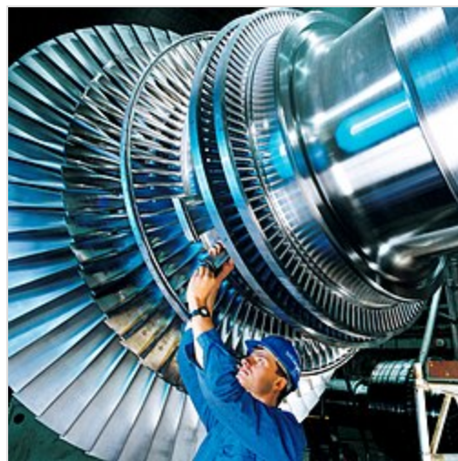
Pracownik instalujący łopatkę na wirniku turbiny parowej w fabryce Siemens w Niemczech
