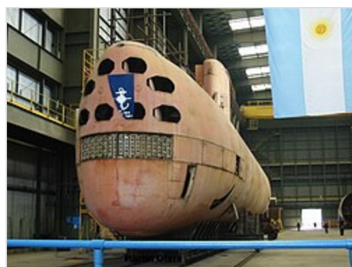
Ośiem wyrzutni torpedowych ARA „San Luis” umieszczonych ponad antenami sonarów okrętu niemieckiego typu 209/1200
