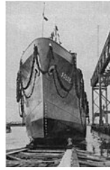
Wodowanie rudowęglowca Sołdek z pochylni wzdłużnej w Stoczni Gdańskiej 6 listopada 1948.
