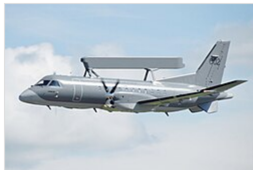
Samoloty wczesnego ostrzegania Saab 340 pełnią rolę latającego centrum dowodzenia operacjami powietrznymi
